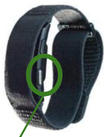
Sensor ECG necesario para la función registro tipo ECG y para la composición corporal (BIA)
